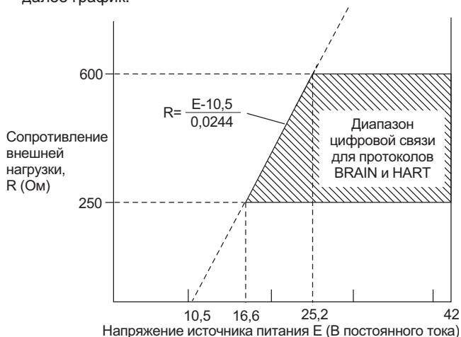
Рис. 2. Взаимосвязь между напряжением источника питания и сопротивлением внешней нагрузки
